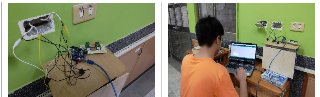
將火線和地線加上繼電器並連接 Arduino 及照度模組進行實驗。
