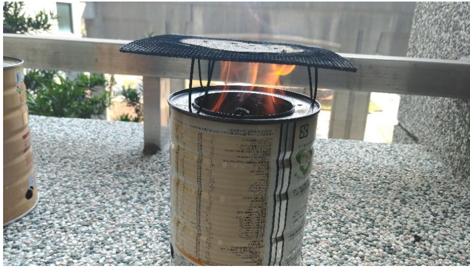
圖九 在內桶上方孔洞燃燒的木煤氣
