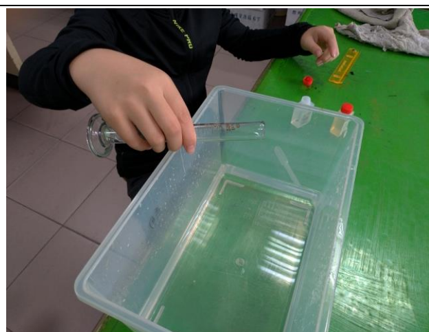
附圖十三：以 1 : 1 : 500 的配方比例調製出水耕液。
