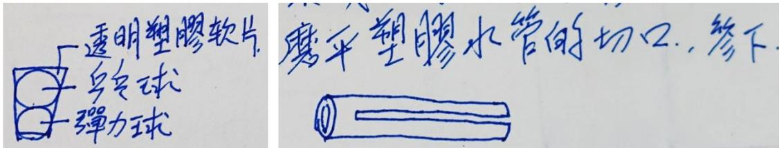
圖 4. 軌道與伽球套的設計，以控制彈跳路徑
