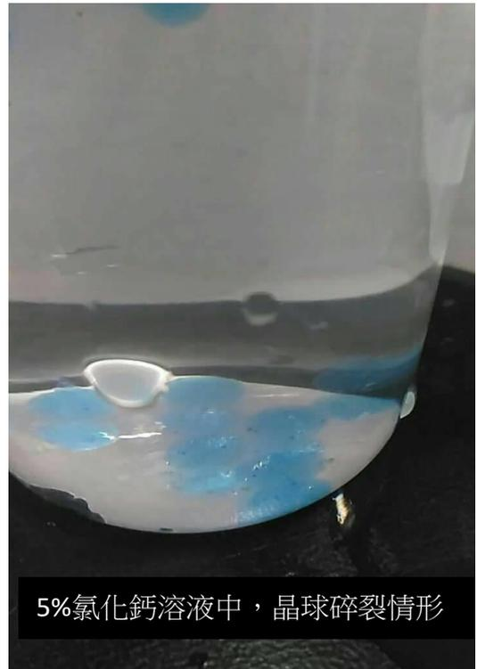
5%氯化鈣溶液中，晶球碎裂情形
