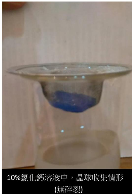
10%氯化鈣溶液中，晶球收集情形
