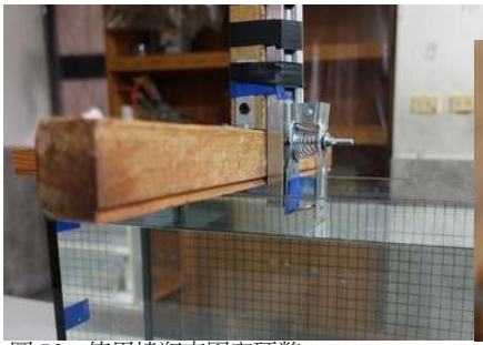
圖 50：使用燒瓶夾固定硬幣
