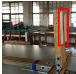
圖 21: 底端黏貼冰棒棍校正鉛直
