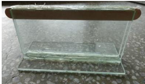
圖 58：以冰棒棍與熱熔膠穩定通道的大小
