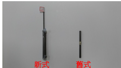
圖 6 改良後製作筆芯電極的方法
