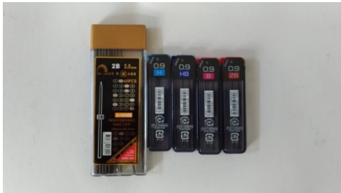
圖 5 改用 0.9m 及 2mm 筆芯為電極材料
