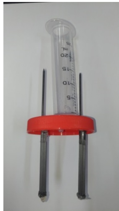
圖 7 將電極固定於蓋子
