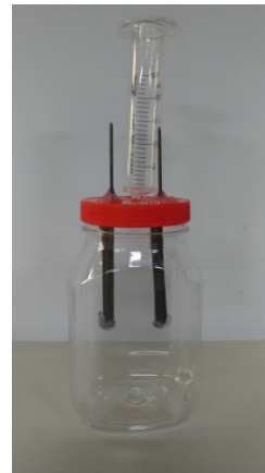
圖 8 第三代反應器構造
