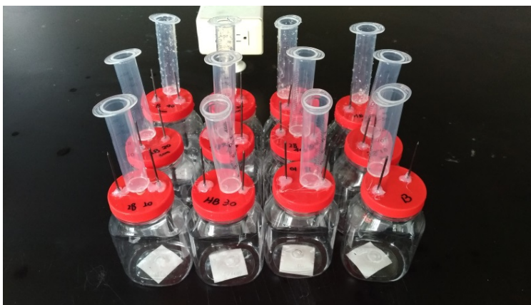
圖 19 本研究自製各式電極的反應器
