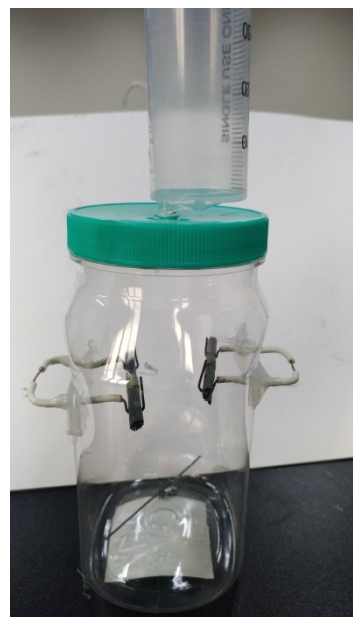
圖 4 第二代反應器構造
