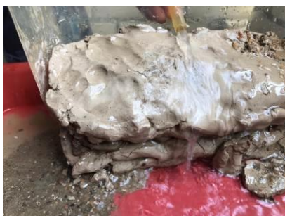
圖 3-17 泥土被水侵蝕到下面的土崩塌。
