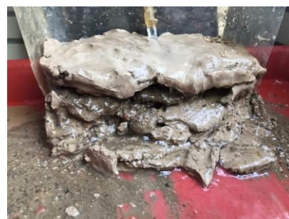
圖 3-18 泥土向下與向側面侵蝕。
