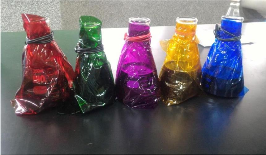
圖（七）：光照實驗包覆的玻璃紙如圖所示。
