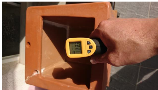
圖 14 測量冰箱內外層溫度
