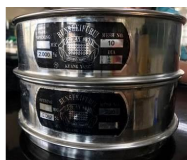
圖 2-4 篩網的孔隙大小是 2.000mm、0.0625mm。
