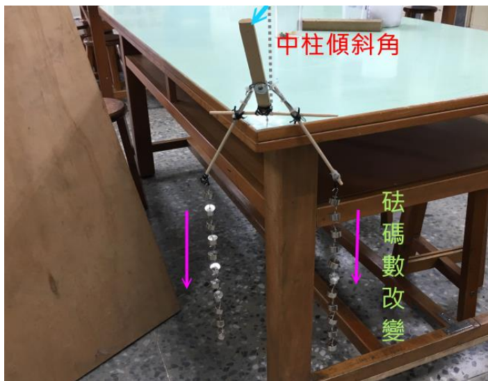
【圖 18】「砝碼重量」對「中柱傾斜角」之影響
