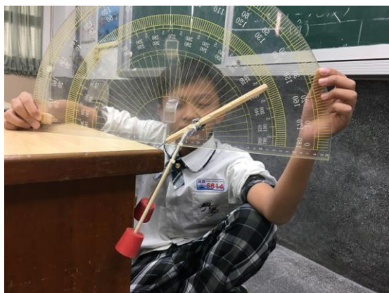
【圖 7】「 重物前移距離 」對「 中柱傾斜角 」之影響（實驗操作）
