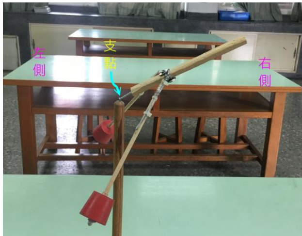
【圖10】「重物前移距離」對「中柱傾斜角」之影響（實驗記錄）
