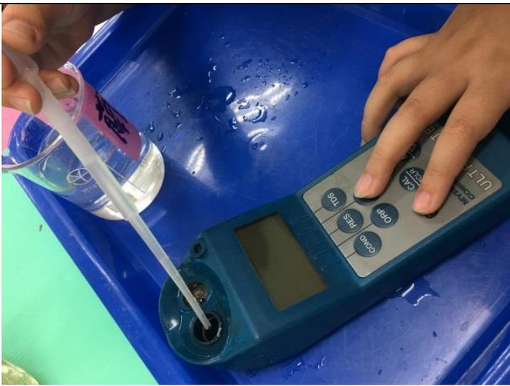
圖二十：將取樣水滴入導電度機中，按下 cond 按鈕。
