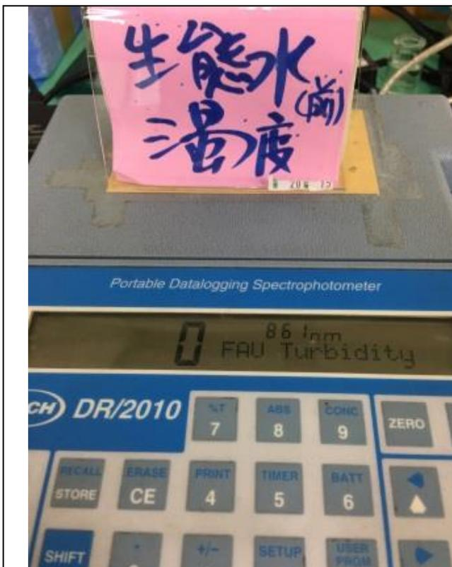
圖二十八：用分光光度計測試生態池的濁度。
