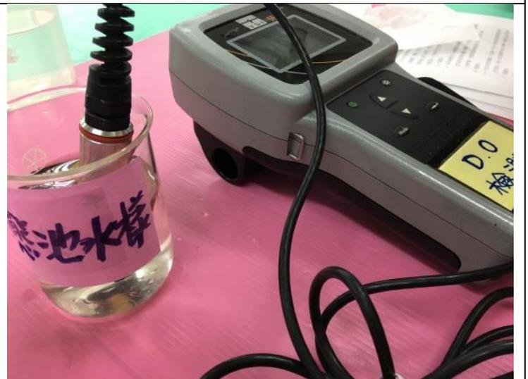
圖十九：測出自來水取樣水的溶氧度。
