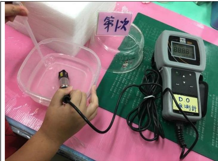
圖十六：將 DO 檢測劑放入水中，停留 1 分鐘以上。
