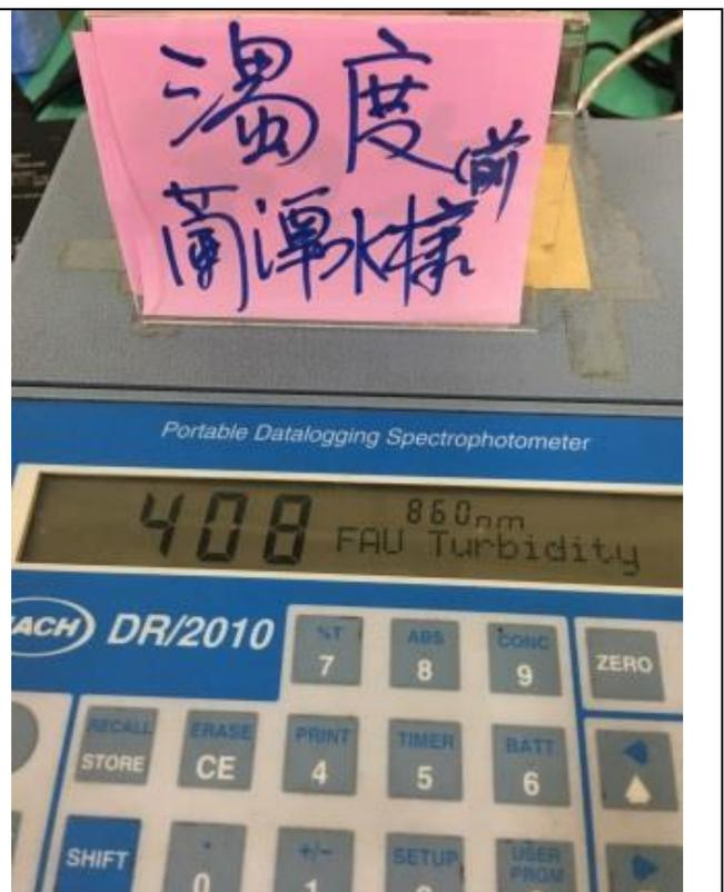
圖二十九：用分光光度計測試蘭潭的濁度。
