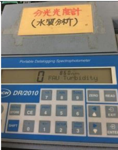
圖三：分光光度計(水質分析檢測用)。
