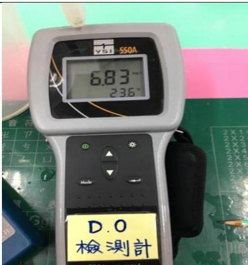
圖十八：測出自來水取樣水的溶氧度。
