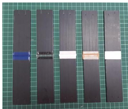
圖 42.不同種類的膠帶，從左到右依序是電氣膠帶、透明膠帶、透氣膠帶、書背膠帶、布紋膠帶。
