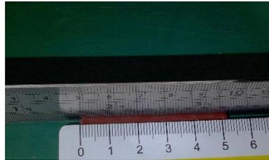
圖 6.橡皮筋(14 番)壓平長度為 5.2 cm
