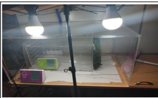
圖二：密室空氣品質測試模擬屋
