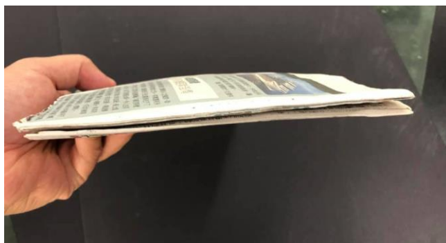
(圖 31 負重的泡水紙張乾燥後沾黏情況嚴重)
