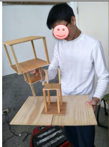
圖十八、實驗後，房屋斷裂。
