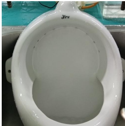
圖七：小便斗原沖水結構(9 孔)
