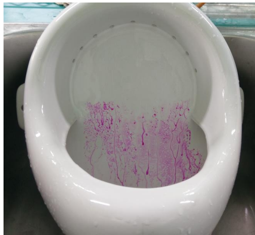
圖十二：原小便斗(9孔)，並連接抽水馬達沖水
