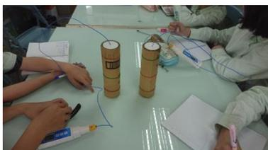
為了解瓦楞紙受外力因素導致原來的厚度降低，可能會影響保溫效果。因此實驗上取二種厚度的瓦楞紙進行壓扁，並與原來未壓扁的瓦楞紙進行保溫效果的分析比較，了解對水溫的影響。
