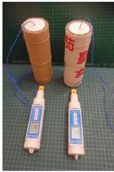
取一種五層裱背的 AB 瓦楞紙，將 A 楞 (波浪大) 放置在接觸壓克力筒，B 楞 (波浪小) 放置在外側；並與 B 楞 (波浪小) 放置在接觸壓克力筒，A 楞 (波浪大) 放置在外側進行比較，並在與原來 A 楞 (波浪大) 同厚度的瓦楞紙做保溫效果的比較，了解 AB 瓦楞紙的保溫效果是否優於 A 楞瓦楞紙。
