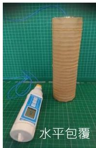
瓦楞紙芯紙波浪方向與壓克力管呈現垂直或水平的不同，可能會影響保溫效果，是值得研究的問題。因此實驗上各取二種不同厚度的瓦楞紙進行水平包覆壓克力管，放入熱水後測試溫度變化，並與原來芯紙垂直方式進行保溫效果的分析比較，了解瓦楞紙芯紙包覆的方向對保溫效果的影響。
