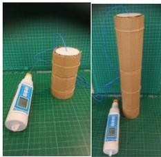
取相同厚度及直徑但不同高度的透明壓克力筒，各放入熱水後各用二種不同厚度的瓦楞紙完全包覆壓克力筒後，測量筒內溫度的變化，了解容器高度對保溫效果的影響。
