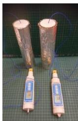
取相同高度、直徑及厚度的透明壓克力管，包覆不同厚度的瓦楞紙後，再包住一層鋁箔紙，做為銀質的材料。待筒內放入熱水後測試水溫變化，瓦楞紙為底加銀色材質對保溫效果的影響。
