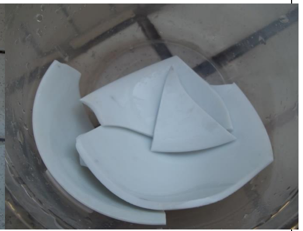
圖片二十：檢視優酪乳修補碗結果
