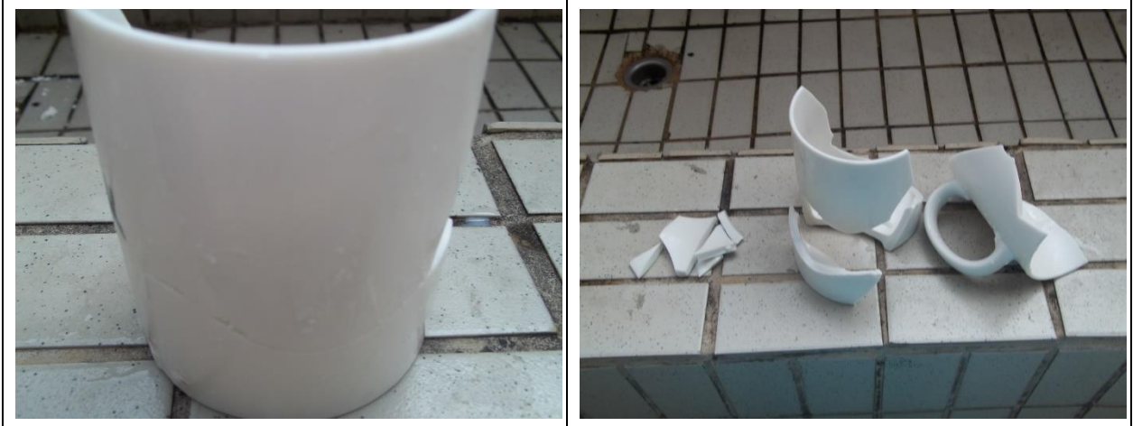
圖片三十一：部分黏住，但一段時間後又裂開
