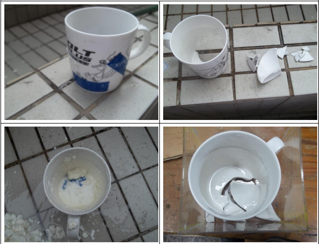
圖片三十：添加檸檬酸鈣修補結果，上：浸泡三天，下：浸泡五天
