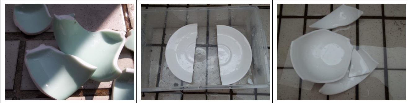
圖片三十三：添加鈣片修補結果，由左至右：小茶杯、盤子、碗
