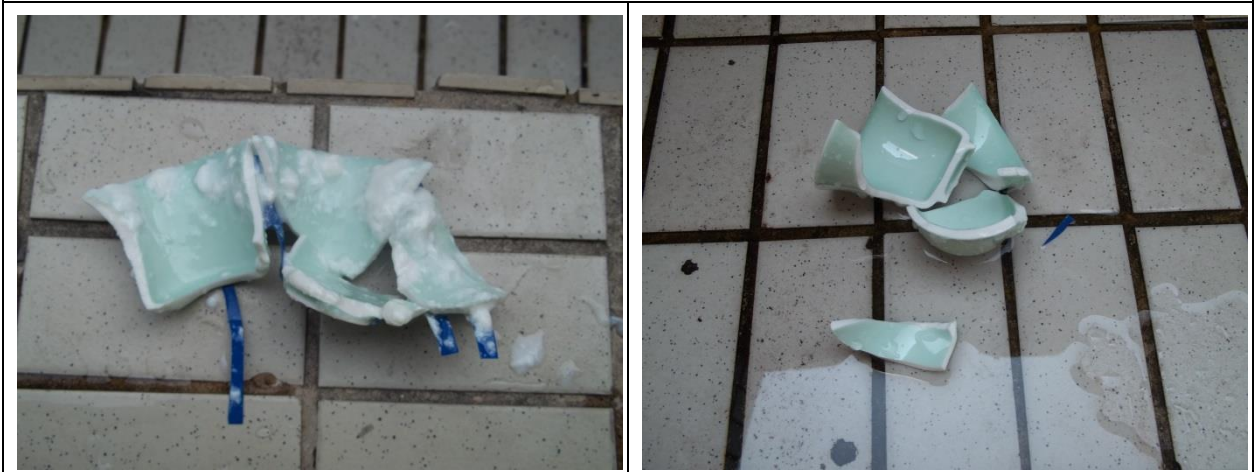
圖片二十二：濃縮牛奶修補結果，左：600 濃縮至 400，右：800 濃縮至 400
