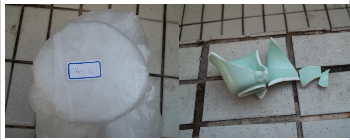
圖片十八：檢視優酪乳修補小茶杯結果
