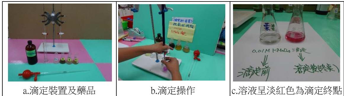
▲ 圖 4.過錳酸鉀滴定法之實驗情形
