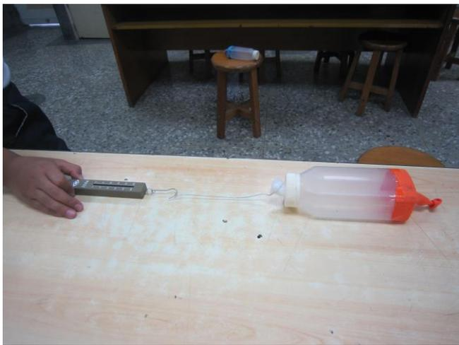
棉球脫離砲口力量測量裝置
