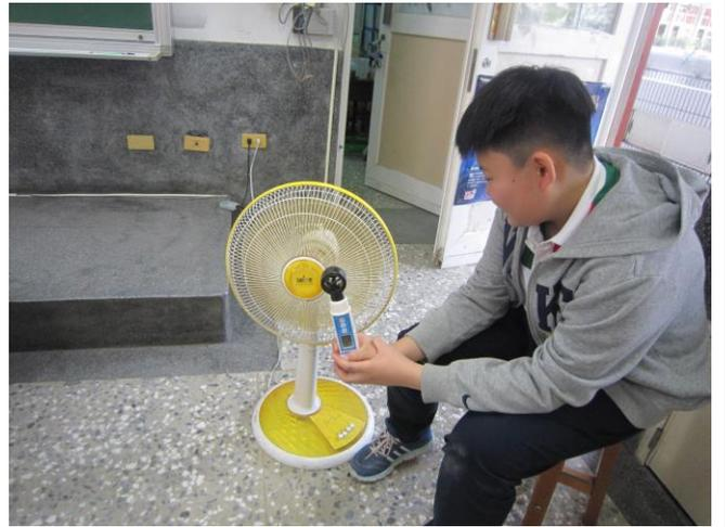
以風速計測試電風扇風速
