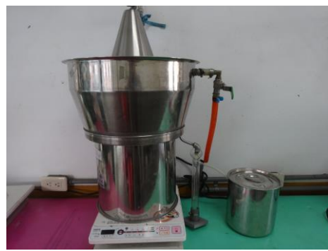
d.上方置入冷凝器開始加熱蒸餾
