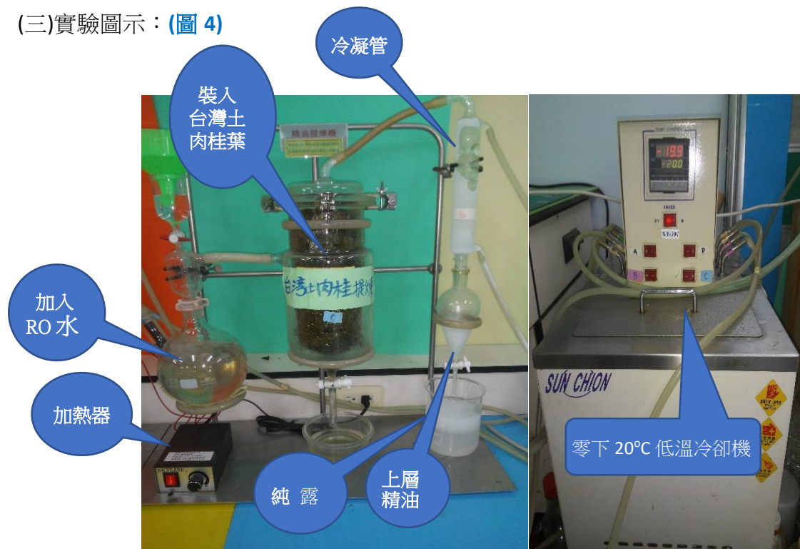
圖 4.以水蒸氣蒸餾法提煉台灣土肉桂精油示意圖
