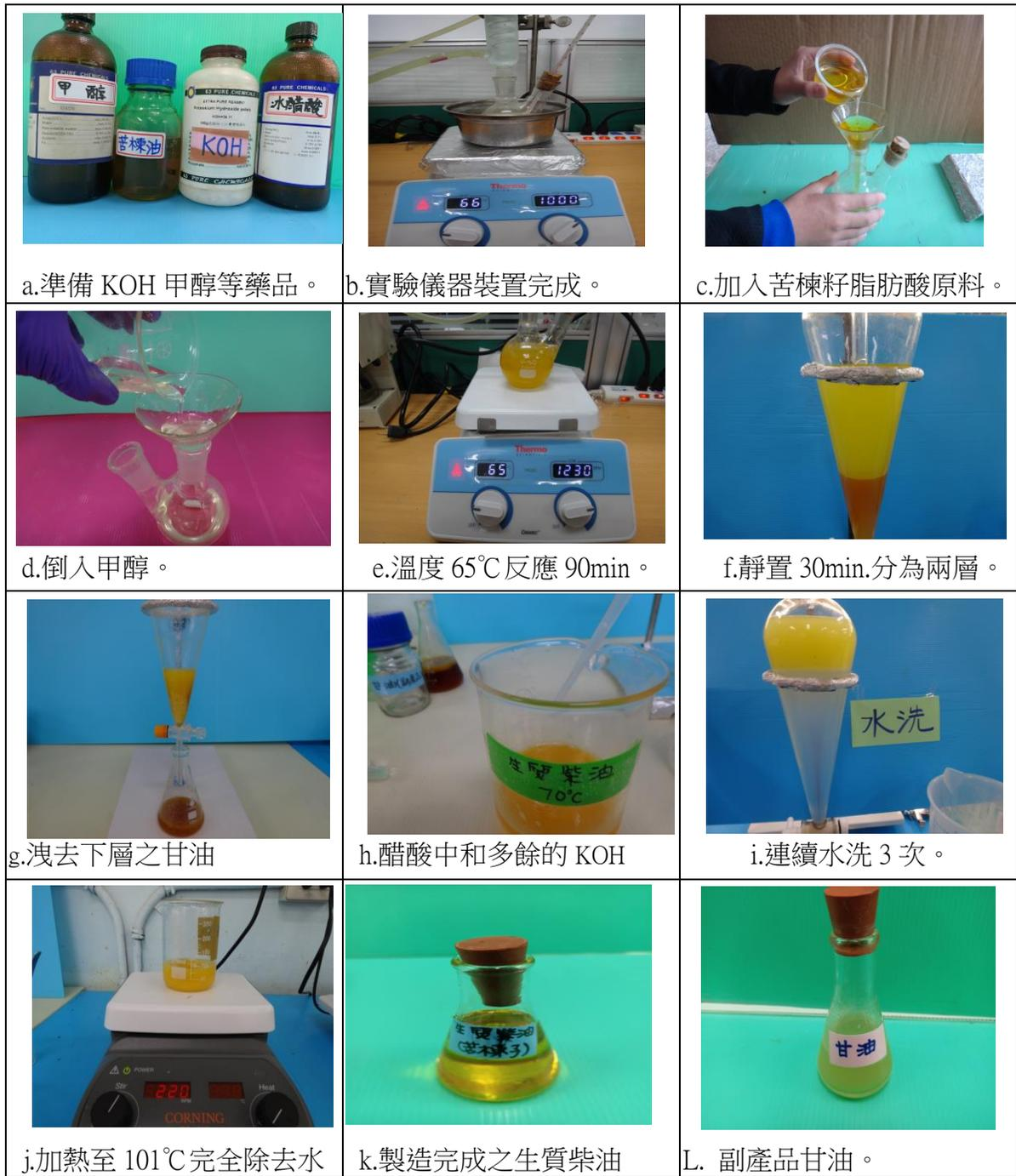
圖6. 以苦楝籽為原料提煉生質柴油操作情形
