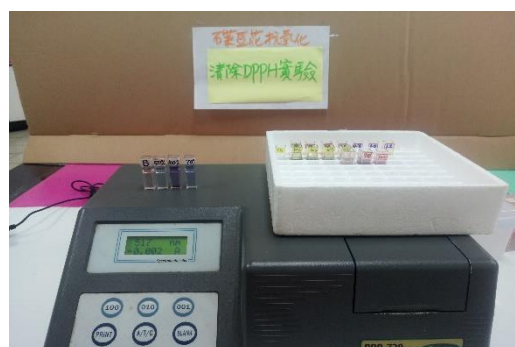
▲ b.準備分光光度計設定 517nm波長
