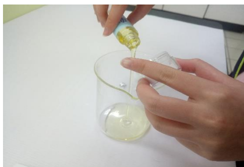
▲b.將植物油與 \text{TiO}_2 及 \text{ZnO} 混合
