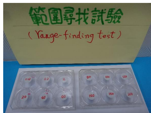
▲ e.各濃度溶液分裝入培養皿中
