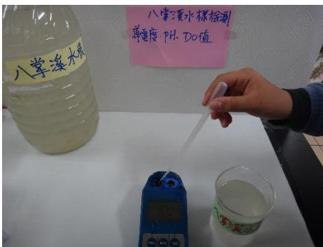
▲ c.做 pH 值檢測及導電度檢測
