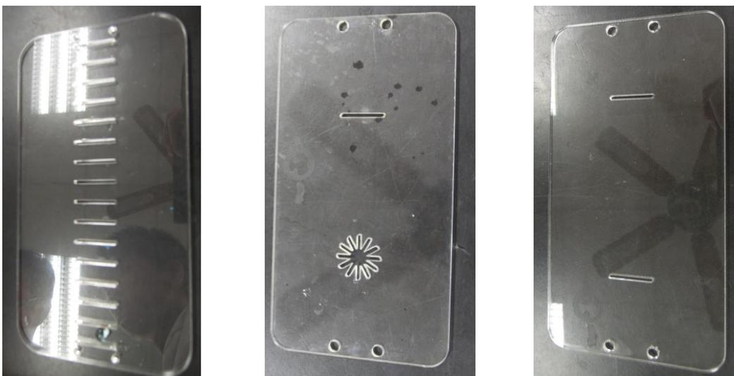
圖二.a 可調整距離的蓋板、圖二.b 可調整角度的蓋板、圖二.c 磁場用蓋板
