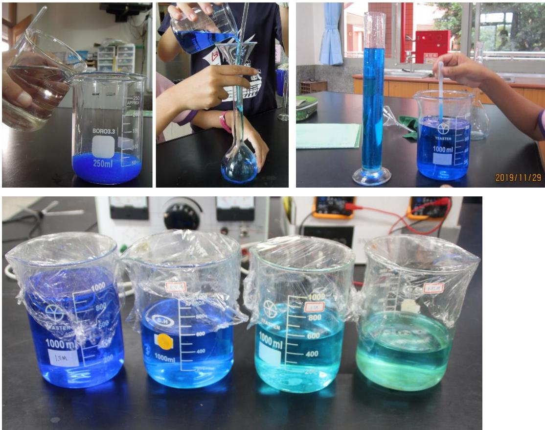
圖 12.配置不同濃度的硫酸銅電鍍液
