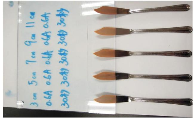
圖十：不同電極距離的電鍍結果
