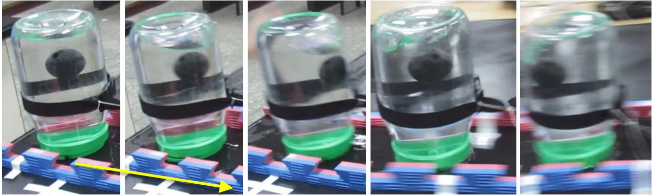
圖 11.a 靜止時 圖 11.b 剛開始向右加速 圖 11.c 重物著地後 圖 11.d 摩擦減速時
