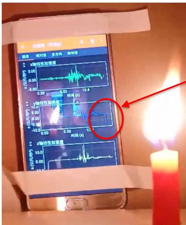
圖 5. 紙箱內攝影可拍到加速度大小並拍到火焰的變形
