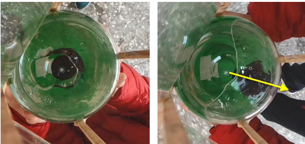
圖 15. 未經運動狀態的球的位置 運動狀態中的球的位置移向圓心
