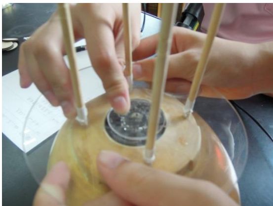
圖一 用三秒膠黏上圓形壓克力片
