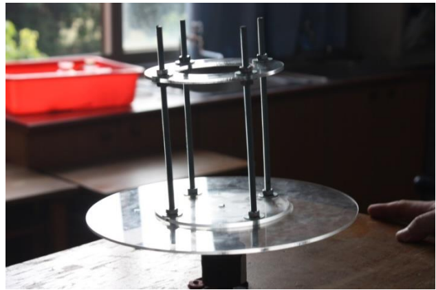
圖五 製作旋轉時，放置水平的裝置
