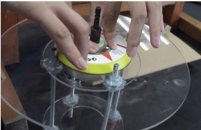
圖六 將打蠟盤黏在壓克力平台上
