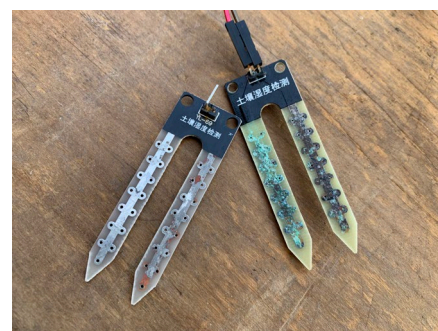
圖二十一：設備腐蝕
