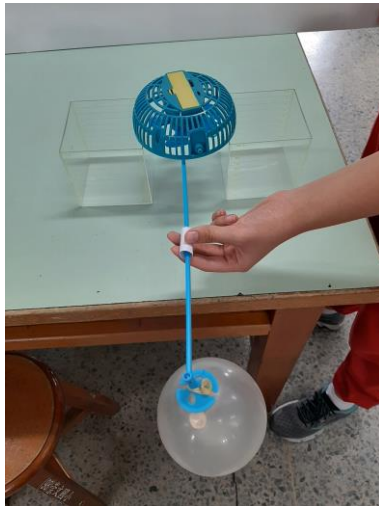
圖 15-2. 機器手臂(小立扇+氣球桿+球拖)-氣球可以旋轉，但旋轉物無法順利沿球壁轉動。
