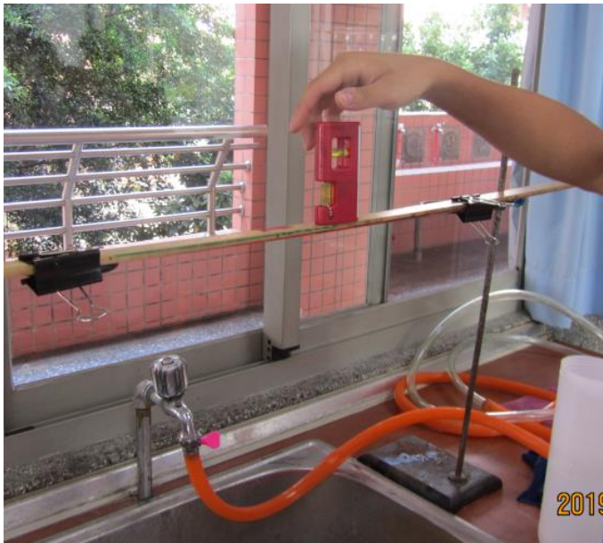
圖三 測量水平儀使木尺水平
