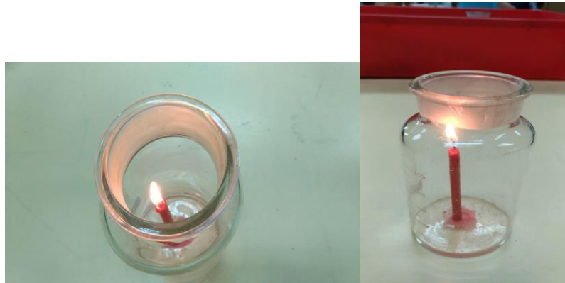
圖 高體積濃度的二氧化碳熱氣流因為沒有頂蓋下降籠罩
