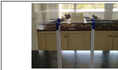
圖 3-1-3：把黏土顛倒固定在支架組
