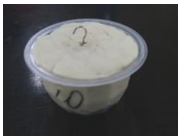
圖 3-1-1：用布丁杯取定量黏土並插入砝碼
