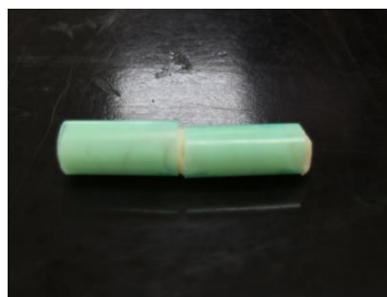
圖 3-2-2：兩段吸管中塞入黏土
