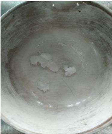
▲圖（八）為硫酸鎂水溶液製成酒精膏的結果。
