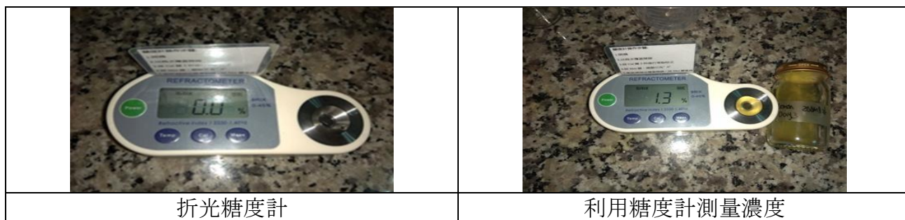
圖四：用折光糖度計測量濃度
