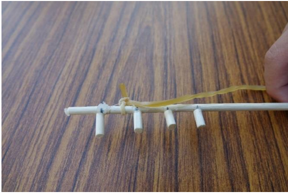
照片1-5：黏貼0.5 cm長竹塊作為橡皮筋打結的卡榫
