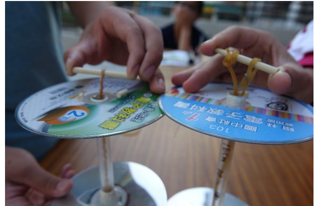
照片2-2：橡皮筋長短相同條數不同(左邊1條橡皮筋，右邊並聯2條橡皮筋)
