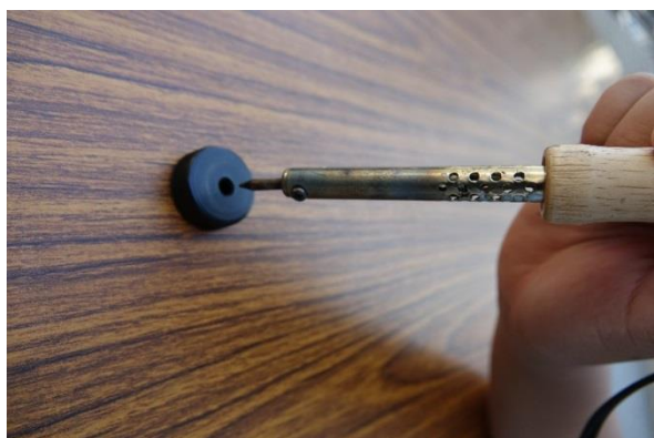
照片1-3：瓶蓋中央利用電烙鐵加熱穿洞
