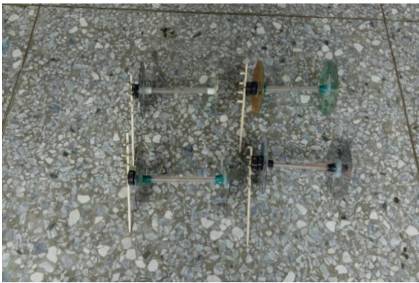
照片2-9：橡皮筋一端固定在轉動支撐軸的卡榫位置不同
