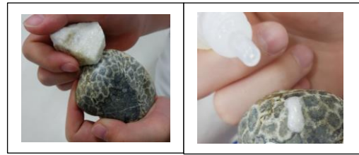
圖 5-1 硬度測試及滴稀鹽酸實驗
