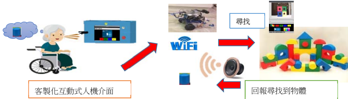
圖三：ihound 互動式人機觸-聲雙控介面之雲端智慧語音獵犬機器人
