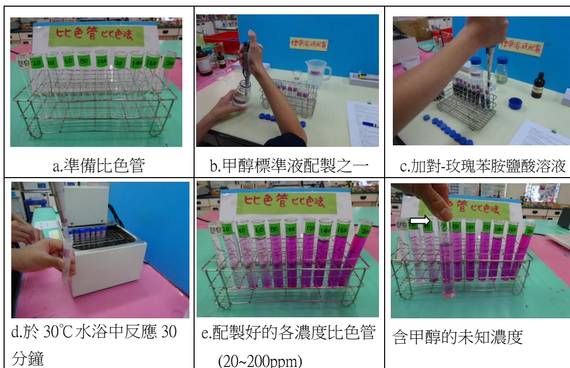
圖 6. 比色管比色法實驗情形
