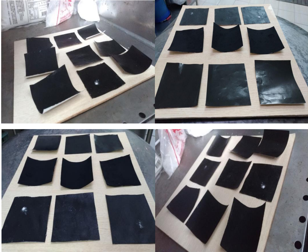
圖 低溫環境中三種不同塗料色紙捲曲情形
