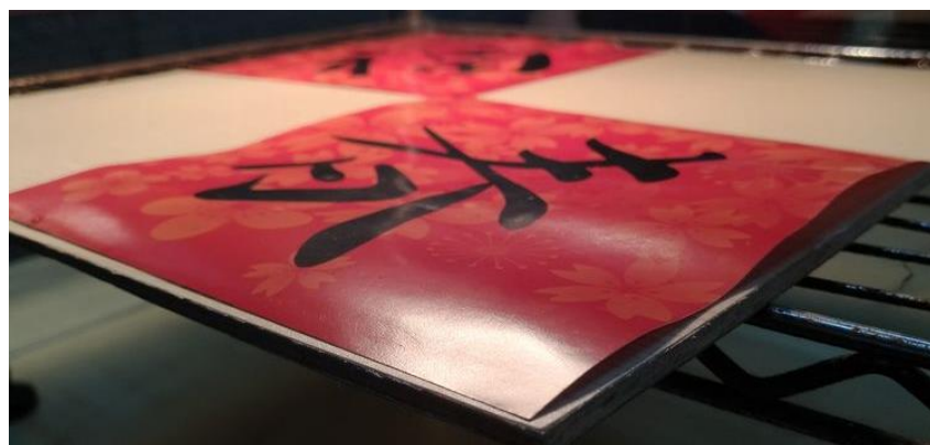
圖 春字因蠟光塗料層熱脹，呈現往下捲曲情形
