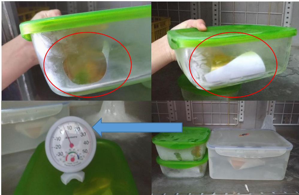
圖 低溫環境-密封保鮮盒中鋁箔色紙明顯捲曲
