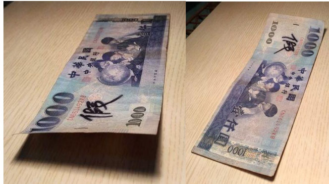
圖 1000元偽鈔照光受熱捲曲情形
