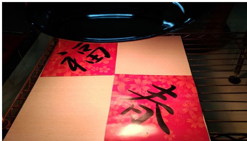
圖 福字噴濕、春字不噴，同時照光加熱
