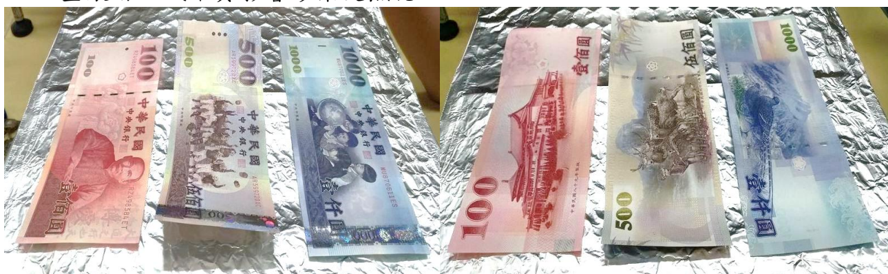
圖 向上均勻加熱，觀察防偽金屬鋁箔條和印刷油墨濃暗區域的捲曲
