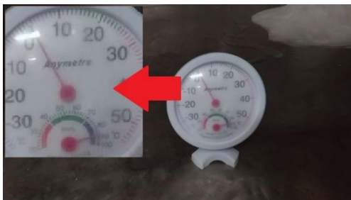
圖 低溫冷藏冰箱溫度約 4^{\circ}\text{C} ，溼度92%
