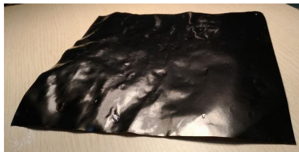
圖 水滴無法均勻滲進黑色塗料層、造成紙張表面起伏不平
