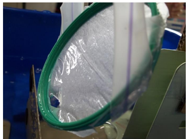
圖片二十二：左 0°撈網破裂情形，右：其它撈網破裂情形
