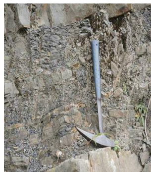
圖 1-14 在砂頁岩互層的地層構造裡，部分為較厚的塊狀砂岩，砂頁岩解理面與河道幾乎呈 90 度的交角。
