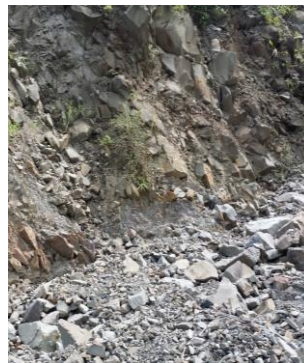
圖 1-18 岩層風化很嚴重，所以崩塌較厲害，碎石的銳角明顯，表示離崩塌的時間不久，距離也不遠。
