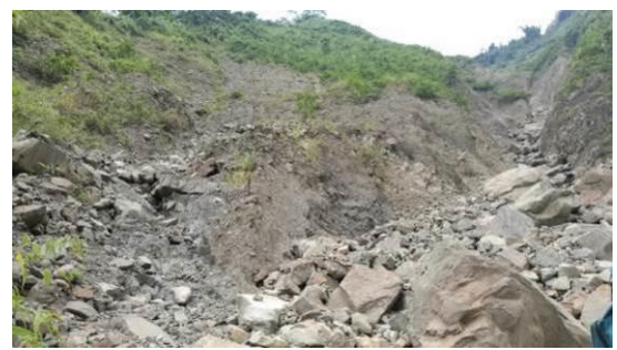
圖 1-20 東邊是露頭四，北偏東 19 度傾斜 11 度，是個崩積層，大約有 20m(七層樓高)，崩塌的很嚴重。
