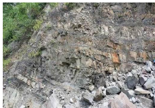
圖 1-13 河道旁露頭三的砂頁岩互層地層，測量結果，傾斜走向的構造為北偏西傾斜 30 度，層面向西傾斜。
