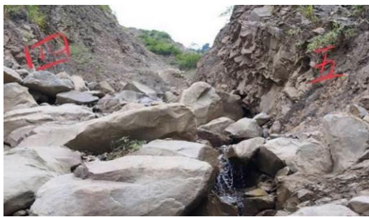
圖 1-25 露頭四在山谷的左側，露頭五在山谷的右側，兩個露頭被河流分開。經測量，露頭五是北偏西 10 度，傾斜 52 度。
